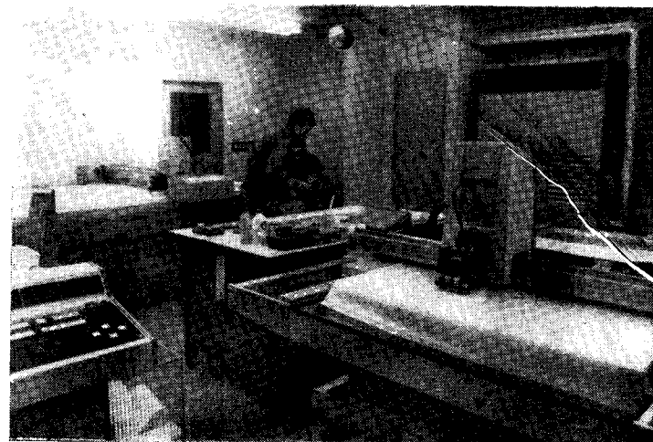
Рис. 62. Автоматическая чертежная машина, широко используемая на японских верфях.
